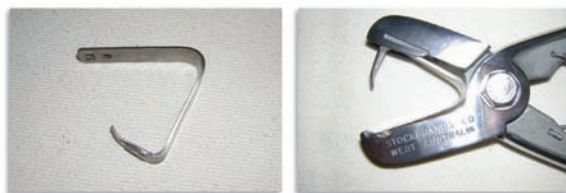
Contoh metal tag (kiri) dan tag yang siap pasang pada applicator (kanan). Tidak boleh menggunakan tang biasa untuk memasang tag ; mesti menggunakan applicator yang khusus didesain untuk itu.
