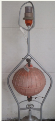
c. Pelampung lampu
